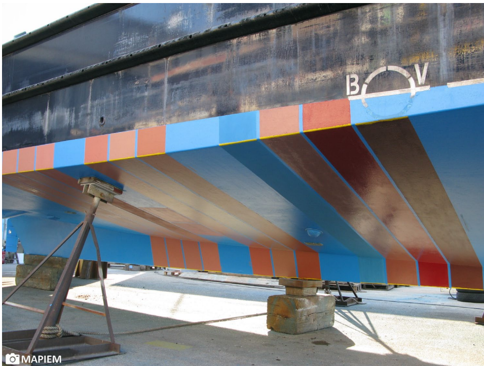
Figure 1 : Essai de matériaux antifouling. © MAPIEM, Université de Toulon
